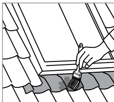
Tætning af inddækning ved ovenlysvinduer.
